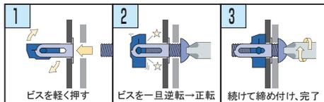
ターンナットを下穴に挿入した後、器材を当てがいビスを指で差し込みます。ビスを軽く押すと、ナットが回転します。
